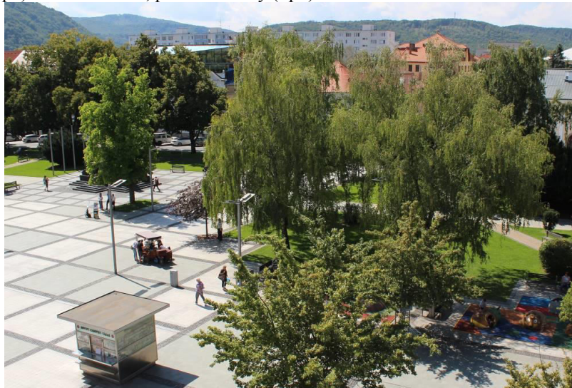
Obrázek 16: Náměstí SNP. Dlažba náměstí světlé barvy (Sp1) má teplotu 36.8 °C, tmavší stříška (Sp2) stánku 59.6 °C, povrch koruny (Sp3) stromu 24.5 °C.
